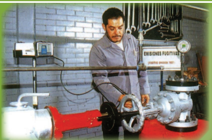
Medición de emisiones con gas Helio, pruebas de apertura y cierre de hasta 1000 ciclos.
