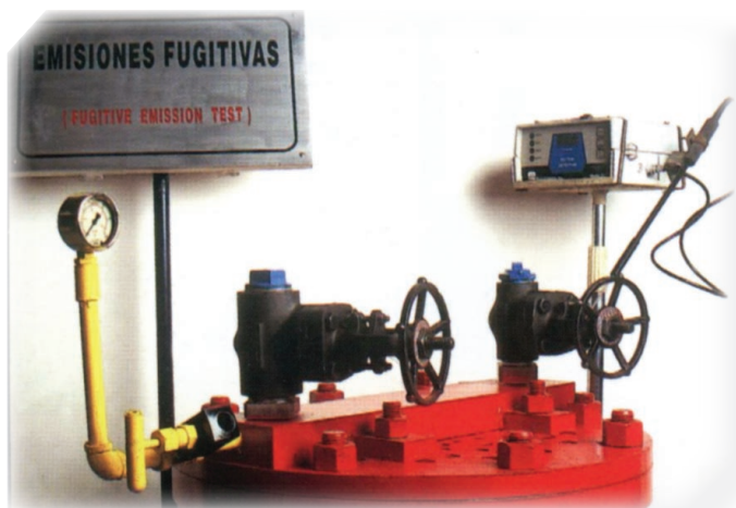
Medición de emisiones a alta temperatura, pruebas de ciclado de hasta 500 ciclos.
